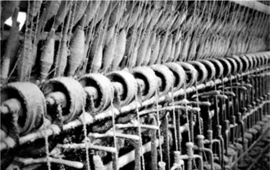
*Détail surréaliste de l'assembleuse-retordeuse à ailettes de la **Sächsische Maschinen**, Chemnitz, 1921, arrêtée "dans son jus" et couverte de fibres de laine émanant des machines voisines, à la filature Ebel de Wasselonne.,*
