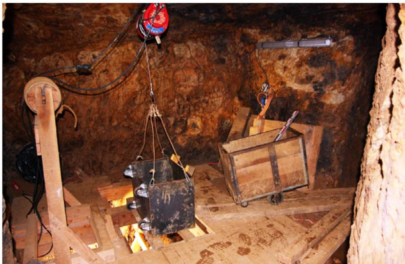
**Fig. 1 :** Sainte-Marie-aux-Mines. Mine *Giro*. TB 0. Salle du puits aménagée pour décombrer le niveau inférieur (aménagement réalisé grâce à l'implication de la société Colas Caméra)
